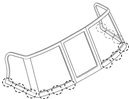
Теперь необходимо установить хвосты боковых элементов рамки тем же способом, предварительно немного поджав боковину, так чтобы она располагалась параллельно коммингсам на консолях.
