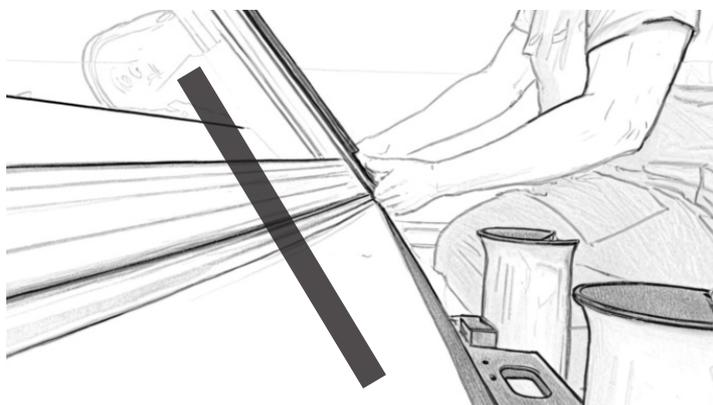
Размещаем передний, ближайший к калитке, край ветрового стекла так, чтобы угол наклона лобовой части образовывал одну линию с наклонённой, передней частью консоли. Проверить совпадение можно с помощью линейки, поставленной на ребро.
