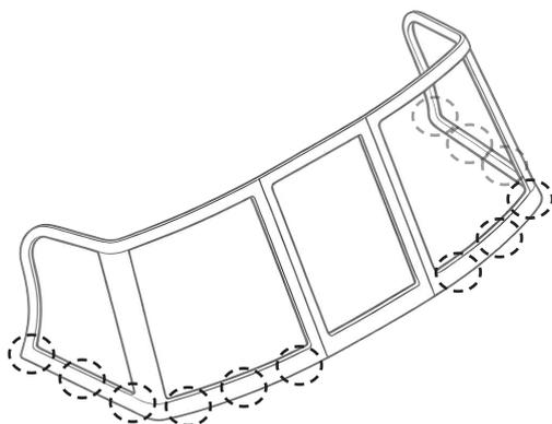
Сквозь отверстия в нижнем профиле рамки, сверлим отверстия в корпусе консолей, в крайних точках лобовой части. То есть около калитки и ближе к углам лобовой части. После чего фиксируем ветровое стекло с помощью саморезов.
