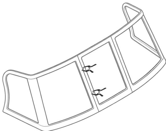
Зафиксируйте створ калитки при помощи струбцин или зажимов обеспечив зазор 3 мм в притворе.
