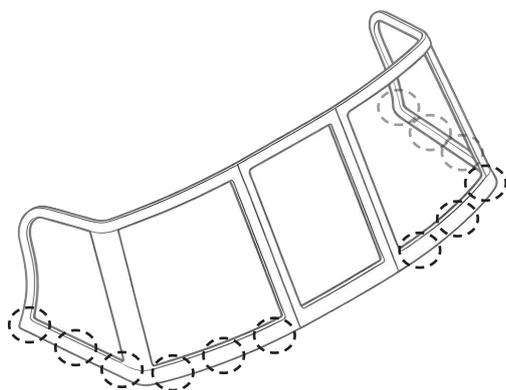
Устанавливаем рамку на место и фиксируем ее на лодке винтами через подготовленные ранее отверстия.
