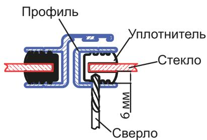
Сверловка бокового профиля для крепления упорных стоек.
