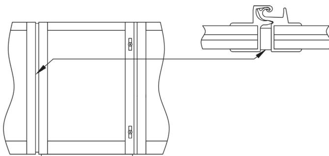
Наклеиваем уплотнитель 6x12 в проём калитки.
