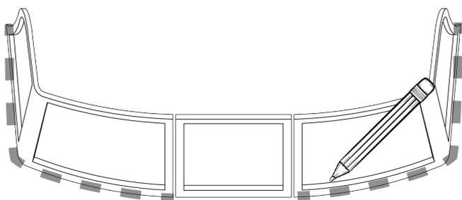
Очерчиваем контур рамки карандашом для наклеивания уплотнителя (под рамку) с клеевой основой.
