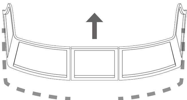
7.1 Откручиваем рамку от палубы лодки и снимаем её.
